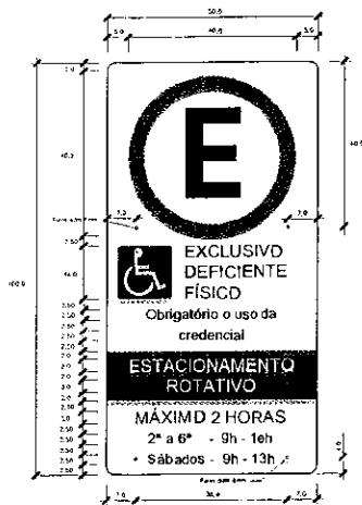
Placa Deficiente Físico
