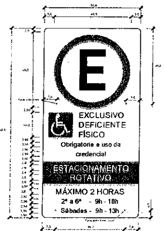
Placa Deficiente Físico
