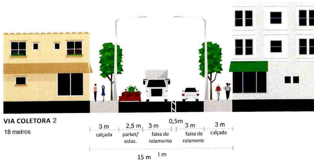
Figura 3 - Perfil da Via Coletora 2
